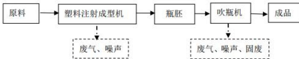
图 3.2-3 瓶装水主要生产工艺流程及产污节点图
